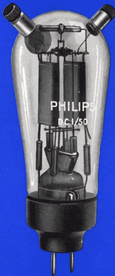
convient pour l'emploi dans de petits émetteurs et amplificateurs de puissance. La faible énergie requise pour le filament est due à la cathode à oxyde du tube.
