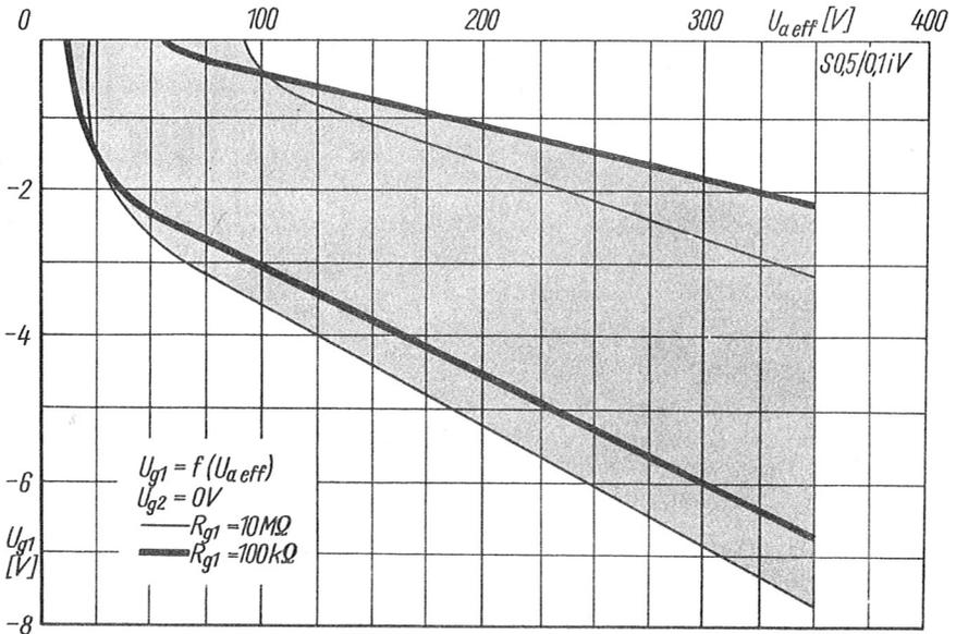
Zündkennlinien-Streubereiche bei  $R_{g1} = 0,1$  MOhm und  $R_{g1} = 10$  MOhm, wie sie durch die Unterschiede bei der Röhrenherstellung, durch Alterungserscheinungen der Röhren sowie durch Unterheizung (5,7V) oder Überheizung (6,9 V) auftreten können.
